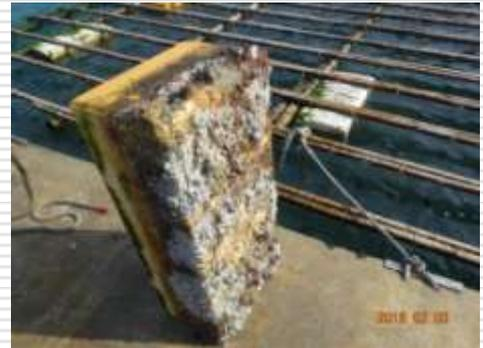
覆網包覆保麗龍浮具，多種材質測試，**耐磨之黑網**成本低並能重複使用多年，漁民接受度高。
